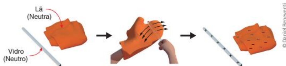
Figura 4 – Neste, os corpos adquirem cargas de sinal contrário, mas de mesmo valor.
